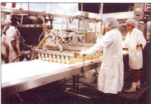
一个主要的美味馅饼、香肠卷设备的设计制造商将不锈钢BN032泵用到香肠卷灌制机上。以5-10m<sup>3</sup>/h的流速把已制备好的香肠肉以连续、均匀的长度输送到馅饼皮盒中。该泵的特点是安装了一个螺旋推进系统从而确保香肠肉从加长的送料斗连续地送入泵的吸入腔。
