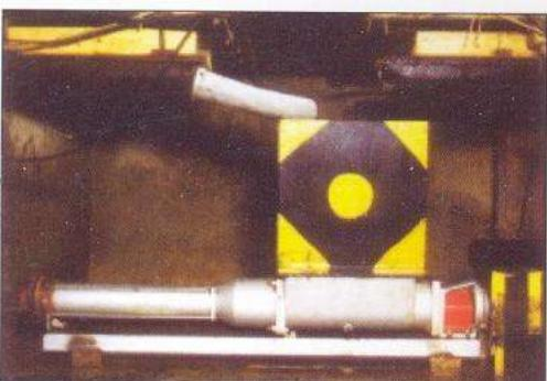
特殊设计的BN082泵在苏格兰的一家制革厂显著的提高了污水处理的效率。以前刮肉是人工从处理区铲到料车上，这种方法劳动强度高。BN系列铸铁泵配有专门改造的大螺旋推进器和料斗以处理这种难以输送的介质。刮肉废料靠重力进入料斗，然后在3bar的压力下以5.5m<sup>3</sup>/h的流量沿着30米的管子直接输送到外面的运料车以备后续处理。
